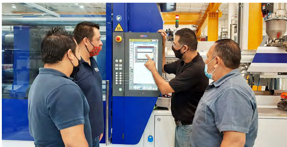
Maschinenbediener von ISGO vor der Unilog B8 Touchscreen-Steuerung einer SmartPower Spritzgießmaschine.
