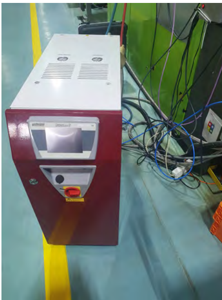
Nachher: Ein Tempro plus D L120 Temperiergerät (Bild links; das „L“ im Namen steht für „large“) mit drehzahl geregelter 4,0 kW Pumpe mit einer Leistung von max. 300 l/min, mit einer maximalen Heizleistung von 36 kW, des weiteren mit einer direkten Kühlleistung bis zu 250 kW. Das Medium Wasser wird hier über ein 2 × 8-faches WFC 100 verteilt (WFC = Water Flow Control), also auf 16 Kühlkreise.
