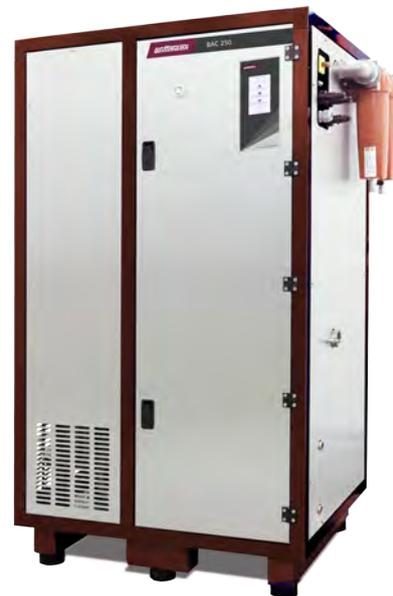
Einer der kritischsten und zugleich der langwierigste Teilprozess beim Extrusionsblasverfahren ist das Kühlen der Kunststoffteile, da das Temperaturgefälle zwischen der mittels Kaltwasser abgekühlten Außenseite und der wärmeren Innenseite Materialstress verursacht. Das verschlechtert die Qualität und kann bei Dichtheits-, Belastungs- oder Fallprüfungen zu Versagen führen.
