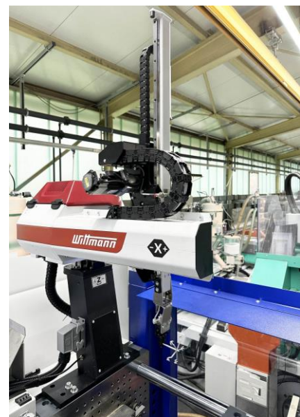
Die neuen Angussentnahmegeräte mit Servo-Drehachse vom Typ WX90 besitzen eine R9-Steuerung und sind damit vollständig in die Produktionszelle integriert.
